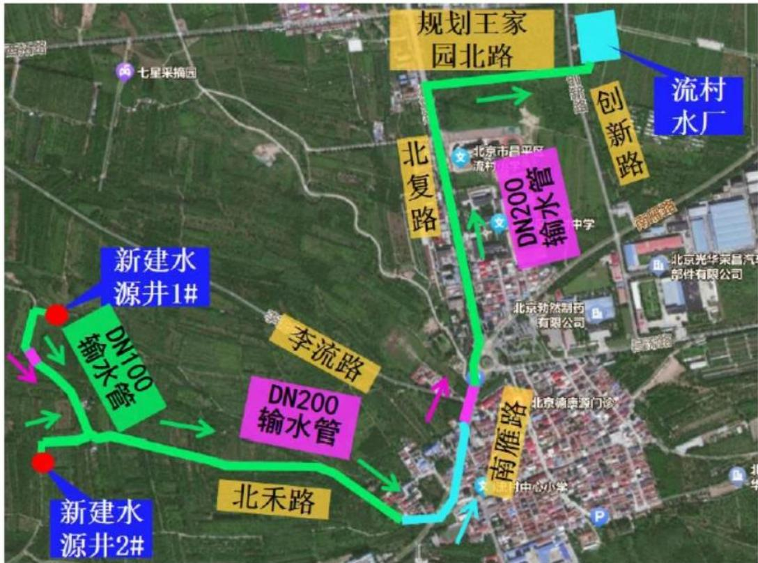
图例：—— 明开施工段 —— 拉管施工段 —— 顶管施工段
