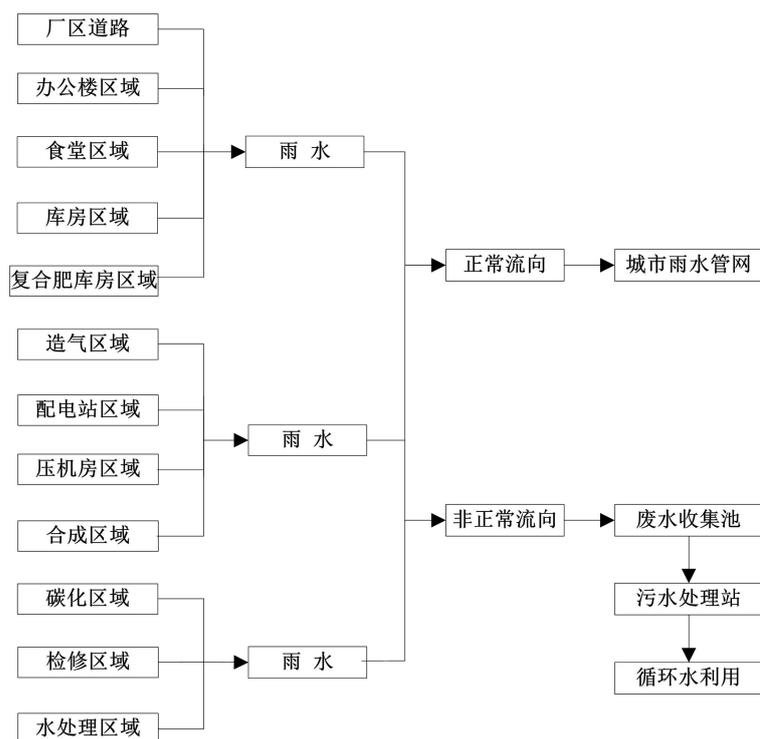
图2-15 雨水排放流程图
