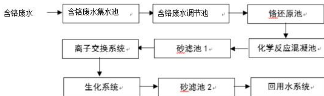
图 4.2-2 基地含铬废水预处理工艺图
