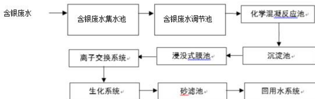
图 4.2-8 含银废水处理工艺图
