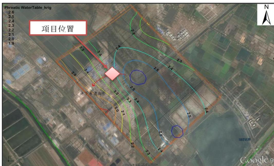
图 2.2-1 潜水水位等值线图
